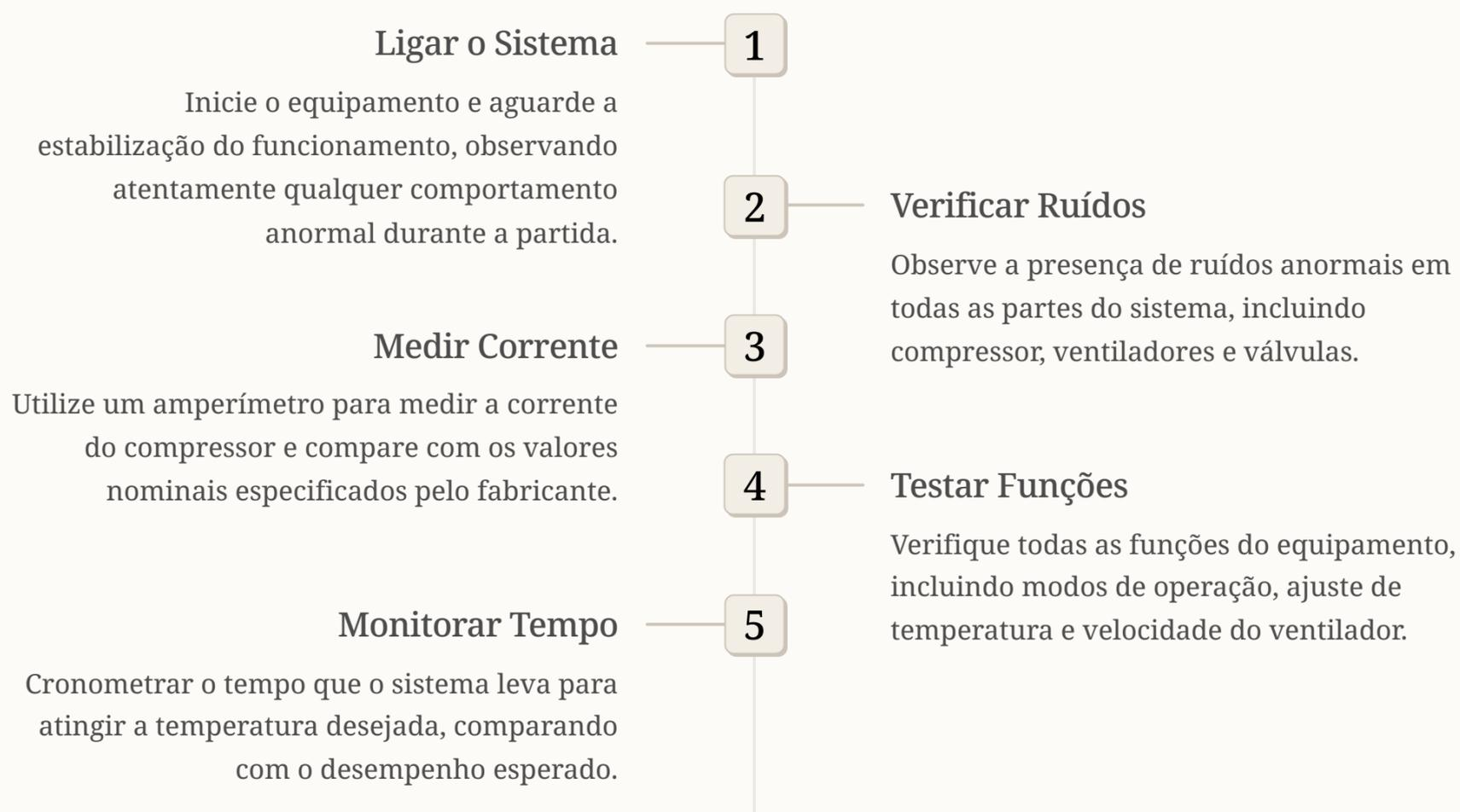
Durante o teste operacional, é importante também verificar se o sistema está atingindo a temperatura programada em um tempo razoável. Um equipamento em boas condições deve ser capaz de reduzir a temperatura do ambiente em aproximadamente 1°C a cada 15 minutos, até atingir a temperatura desejada. Tempos significativamente maiores podem indicar problemas no sistema de refrigeração ou subdimensionamento do equipamento para o ambiente.
